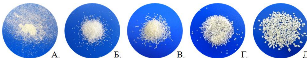
Рисунок 7. Фотографии образцов различных фракций крошки из ДКМ разного диаметра. А – 40-125 мкм, Б – 125-250 мкм, В – 250-500 мкм, Г – 500-1000 мкм, Д – 1-2 мм.
