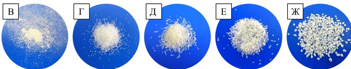
Рисунок 1. Фотографии образцов ДКМ в разных формах исполнения: А – клинья и блоки, Б – губчатые пористые мембраны, В-Ж – фракции крошки с частицами различного диаметра (В – 40-125 мкм, Г – 125-250 мкм, Д – 250-500 мкм, Е – 500-1000 мкм, Ж – 1-2 мм).
